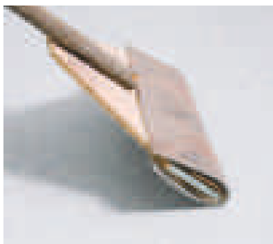
20. Hõõru katet vuugi kohal nii, et vuuk oleks ühtlane ja tihe. Hõõru paanid põrandale kinni keskelt äärte suunas ja kontrolli, et paanide alla ei jääks õhumulle.
